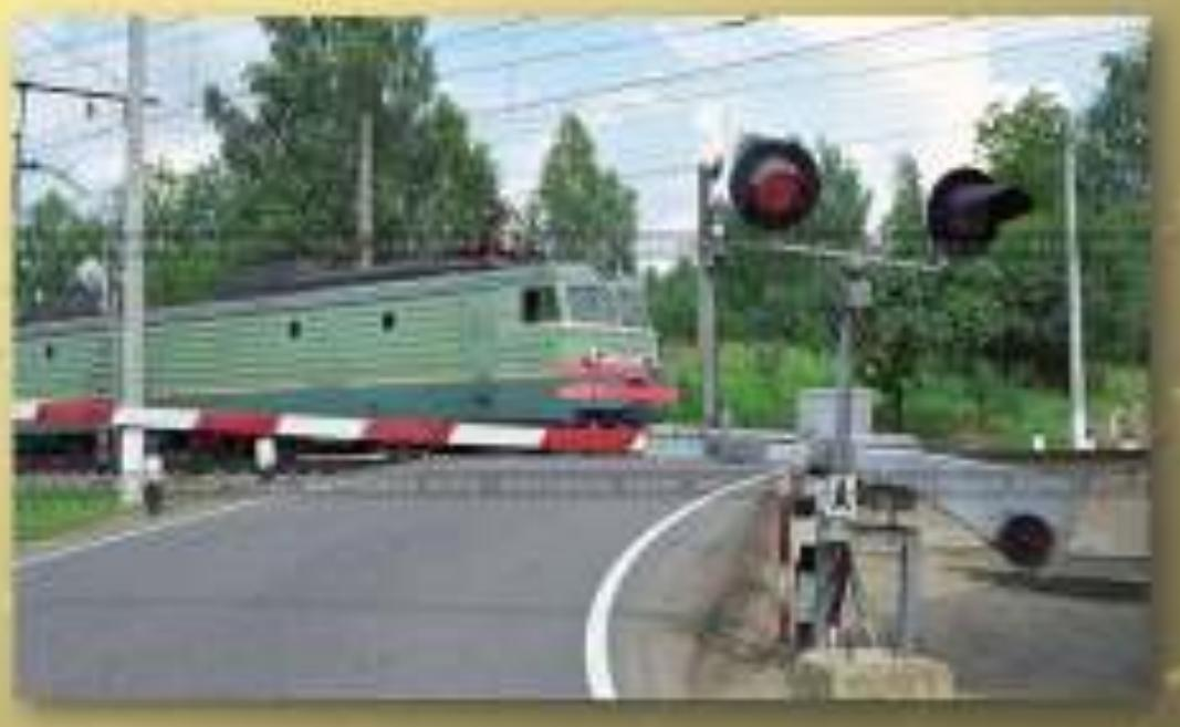
**Штамбум** [нем. *штамм* — ствол] — устройство для быстрого преграждения и освобождения пути в виде поворачивающейся вокруг горизонтальной или вертикальной оси стрелы
